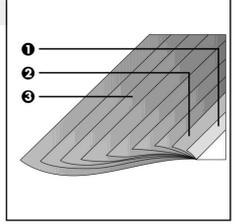
**FR** Le stratifié à haute pression est constitué d'un empilement de feuilles de papier imprégnées de résines thermodurcissables, qui sont polymérisées sous l'effet d'une pression (8 MPa) et d'une température élevée (150°C) :
